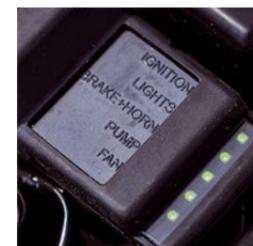
Coté électronique, petite révolution avec cette nouvelle Unité de Contrôle Offroad. Situé sous la selle, elle remplace les fusibles et relais électroniques. L'état de chaque sortie est indiqué par un voyant LED rouge ou vert, ce qui permet de détecter facilement les dysfonctionnements.
